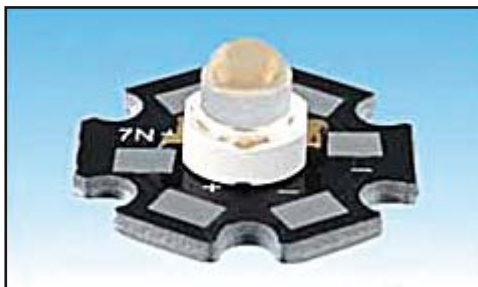
Obr. 2 Výkonová LED na tepelně vodivém spoji
