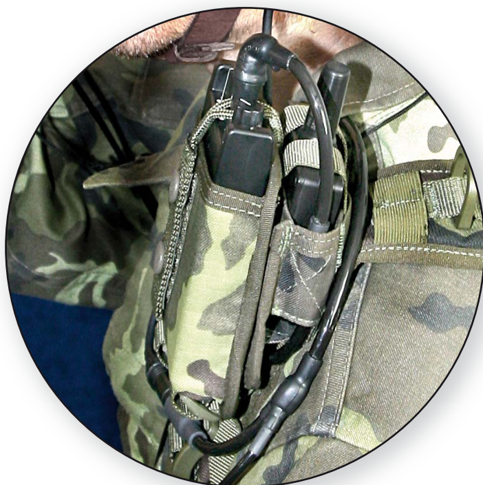
Obr. 1: Detail osobní verze RDE20 spolu s radiostanicí PR20
